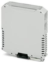
Custodie per guide DIN, Custodia completa con piedino di fissaggio in metallo, design alto, con feritoie di ventilazione, larghezza: 22,6 mm, altezza: 99 mm, profondità: 113,65 mm, colore: grigio chiaro (simili RAL 7035), collegamento trasversale: Connettore per guide di supporto (opzionale), n. poli connettore trasversale: 5
