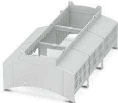
Custodia per guide DIN per l'impiego nei ripartitori di installazione a norma DIN 43880, parte superiore custodia modulare, larghezza: 161,6 mm, altezza: 89,7 mm, profondità: 54,85 mm, colore: grigio chiaro (simili RAL 7035)
