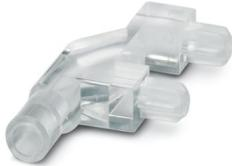
Conduttore di luce multiplo, passivo, rigido, Testa cilindrica, superficie di emissione: planare, numero di indicatori: 1, (1 serie, 1 colonna), passo: 5,08 mm, protezione ESD: <10 kV, utilizzabile per le custodie ME, ME MAX, ME-IO, ME PLC e EH (modifica della custodia necessaria)
