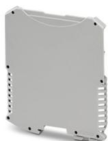
Custodie per guide DIN, Semiguscio della custodia (di sinistra), tipo alto, con feritoie di ventilazione, larghezza: 6,3 mm, altezza: 99 mm, profondità: 112,85 mm, colore: grigio chiaro (simili RAL 7035), collegamento trasversale: Connettore per guide di supporto (opzionale)
