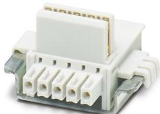
Connettore per guide di supporto, colore: grigio chiaro, corrente nominale: 8 A, 8 A (contatti paralleli) (contatti seriali), tensione di dimensionamento (III/2): 50 V, numero poli: 5, serie di prodotti: TBUS5-22,5..., passo: 3,81 mm, montaggio: Montaggio su guida DIN, bloccaggio: assente, tipo di fissaggio: assente, Articolo con contatti dorati, connettore bus per il collegamento con custodie per l'elettronica, 4 contatti paralleli/1 contatto seriale
