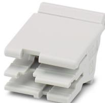
Connettore Power per custodia ME MAX, larghezza 22,5 mm, 2 poli, utilizzo per la trasmissione di una corrente cumulativa da massimo 42 A con 60 V DC.
