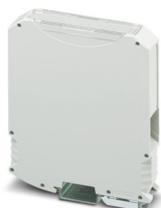
Custodie per guide DIN, Custodia completa con piedino di fissaggio in metallo, design alto, senza feritoia di ventilazione, larghezza: 17,6 mm, altezza: 99 mm, profondità: 113,65 mm, colore: grigio chiaro (simili RAL 7035), collegamento trasversale: Connettore per guide di supporto (opzionale), n. poli connettore trasversale: 5
