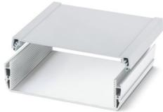
Custodie profilate, Montaggio a parete (opzionale con accessori), Profilo in alluminio, in 2 parti, larghezza profilo (interno): 161 mm, larghezza profilo (esterna): 187 mm, lunghezza: 1000 mm, altezza: 187 mm, profondità: 54,6 mm
