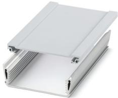
Custodie profilate, Montaggio a parete (opzionale con accessori), Profilo in alluminio, in 2 parti, larghezza profilo (interno): 78 mm, larghezza profilo (esterna): 98,5 mm, lunghezza: 200 mm, altezza: 98,5 mm, profondità: 38,2 mm
