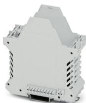
Custodie per guide DIN, Base custodia con piedino di fissaggio in metallo, design alto, con feritoie di ventilazione, larghezza: 45,2 mm, altezza: 99 mm, profondità: 107,3 mm, colore: grigio chiaro (simili RAL 7035), collegamento trasversale: connettore bus integrato, n. poli connettore trasversale: 10+2, Connettore bus: 10 contatti paralleli, 2 contatti seriali
