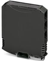
Custodie per guide DIN, Custodia completa con piedino di fissaggio in metallo, design alto, con feritoie di ventilazione, larghezza: 22,6 mm, altezza: 99 mm, profondità: 113,65 mm, colore: nero (simili RAL 9005), collegamento trasversale: Connettore per guide di supporto (opzionale), n. poli connettore trasversale: 5
