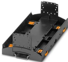
Custodia per guide DIN per l'impiego nei ripartitori di installazione a norma DIN 43880, Base custodia con piedino di fissaggio, larghezza: 161,6 mm, altezza: 89,7 mm, profondità: 48,9 mm, colore: nero (simili RAL 9005), collegamento trasversale: Connettore per guide di supporto (opzionale), n. poli connettore trasversale: 16
