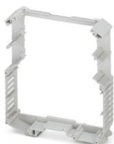
Custodie per guide DIN, Elemento intermedio, di tipo alto, con feritoie di ventilazione, larghezza: 22,6 mm, altezza: 99 mm, profondità: 112,85 mm, colore: grigio chiaro (simili RAL 7035)
