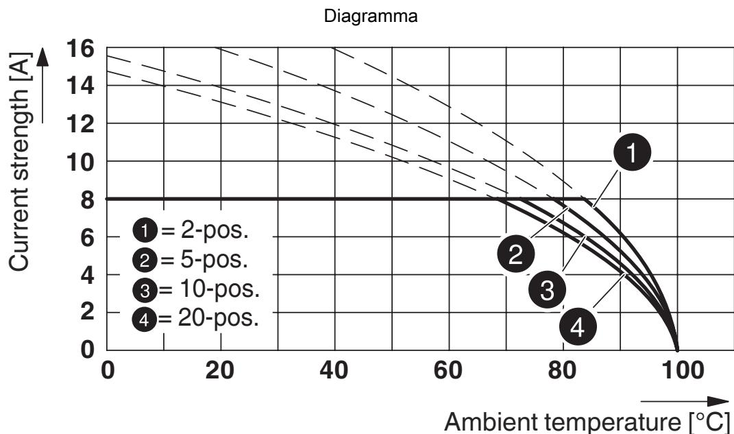
Tipo: FRONT-MC 1,5/...-STF-3,81 AU con MCV 1,5/...-GF-3,81 AU
