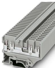
Morsetto passante, tensione nominale: 500 V, corrente nominale: 29 A, 1. Piano attacco sinistra, tipo di connessione: Connessione a vite, Sezione di dimensionamento: 4 mm<sup>2</sup>, sezione: 0,2 mm<sup>2</sup> - 4 mm<sup>2</sup>, tipo di connessione: Connessione Faston, montaggio: NS 35/7,5, NS 35/15, NS 32, colore: grigio
