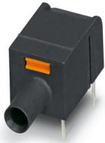
Morsetto circuito stampato, sezione nominale: 0 mm<sup>2</sup>, numero dei potenziali: 1, numero di file: 1, numero di poli per fila: 1, serie di prodotti: FOPT, passo: 10,16 mm, tipo di connessione: Connessione a molla Push-in, montaggio: Saldatura a onde, direzione di collegamento conduttore/scheda: 0 °, colore: verde, Layout Pin: Pinning lineare, Lunghezza pin [P]: 4 mm, numero di pin di saldatura per potenziale: 4, tipo di confezione: confezionato nel cartone
