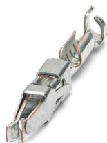
Il contatto femmina a crimpare viene inserito nella custodia della spina dopo aver crimpato il conduttore del connettore modulare MCC 1...-STZ-3,81 e MCC 1...-STZF-3,81 per sezioni da 0,2 mm<sup>2</sup> fino a 0,34 mm<sup>2</sup>
