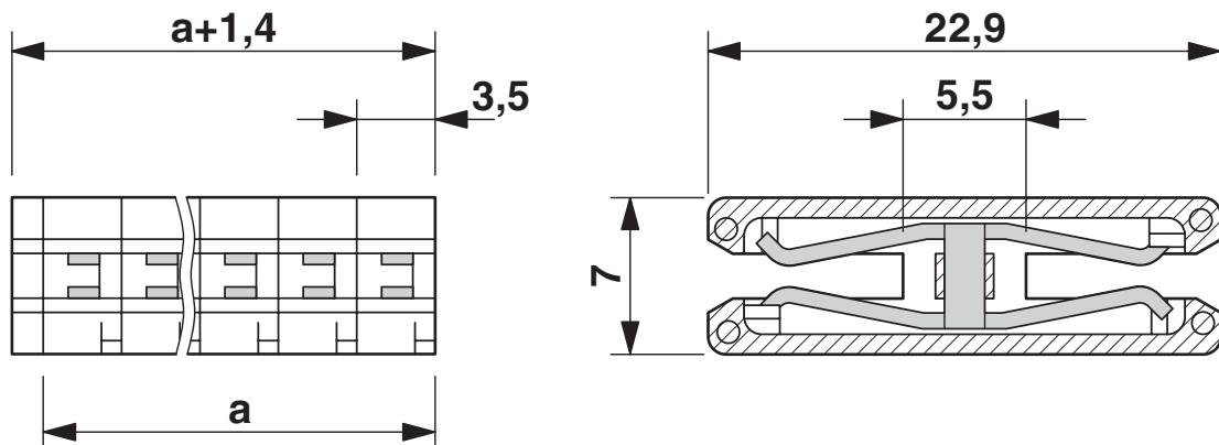
Dima di forat./geometria di pad di saldat.
