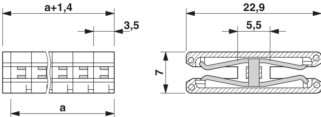
Dima di forat./geometria di pad di saldat.
