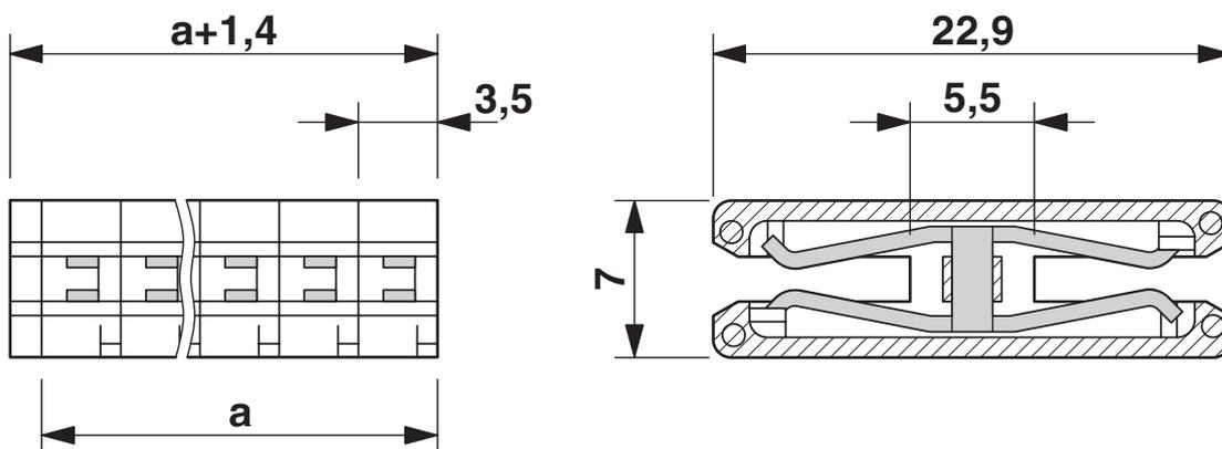
Dima di forat./geometria di pad di saldat.
