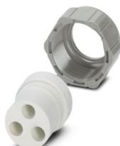
Connessione a vite parziale Pg21, in plastica, costituita da guarnizione in gomma con più fori (3 x 7 mm) e una ghiera di serraggio, per perni pressacavi VC-M-KV-Pg21.....
