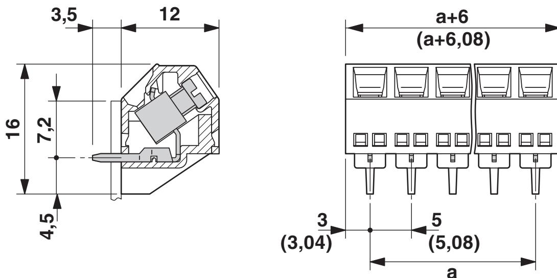
Dima di forat./geometria di pad di saldat.
