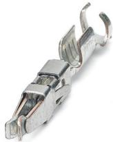
Il contatto femmina è inserito nella custodia della spina dopo aver crimpato il conduttore per connettore modulare MCC 1...-STZ-3,81 e MCC 1...-STZF-3,81 per campi di sezioni da 0,5 mm<sup>2</sup> fino a 1 mm<sup>2</sup>
