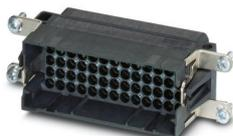
Inserto contatti, Serie di prodotti: VARIOCON, tipo: VC4, numero poli: 65, sezione del conduttore min.: 0,14 mm<sup>2</sup>, sezione del conduttore max.: 1,5 mm<sup>2</sup>, tensione di dimensionamento: 250, corrente nominale: 10 A, Tipo di connessione: Connessione a crimpare, Tipo di connessione del contatto: Spina, i connettori possono essere estratti esclusivamente in assenza di tensione.
