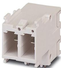
Inserto contatti, Serie di prodotti: VARIOCON, colore: grigio chiaro, numero poli: 2, tensione di dimensionamento: 400, corrente nominale: 20 A, Tipo di connessione: Connessione di circuiti stampati, Tipo di connessione del contatto: Spina, i connettori possono essere estratti esclusivamente in assenza di tensione.
