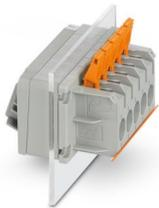
Morsetto d'esecuzione, tipo di connessione: Connessione Push-Lock, Connessione a molla Push-in, numero poli: 4, corrente di carico: 41 A, sezione: 2,5 mm<sup>2</sup> - 16 mm<sup>2</sup>, direzione di connessione del conduttore alla direzione di inserzione: 0 °, larghezza: 64,4 mm, colore: grigio
