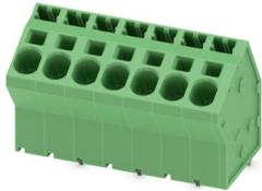
Morsetto circuito stampato, corrente nominale: 41 A, tensione di dimensionamento (III/2): 1000 V, sezione nominale: 6 mm<sup>2</sup>, numero dei potenziali: 7, numero di file: 1, numero di poli per fila: 7, serie di prodotti: SPTA 5/, passo: 7,5 mm, tipo di connessione: Connessione a molla Push-in, montaggio: Saldatura a onde, direzione di collegamento conduttore/scheda: 60 °, colore: verde, Layout Pin: Pinning a zigzag W, Lunghezza pin [P]: 4,6 mm, tipo di confezione: confezionato nel cartone
