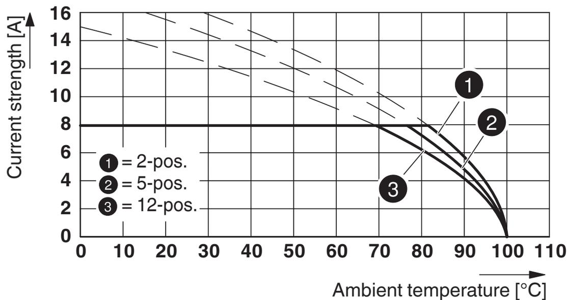
Tipo: FMC 1,5/...-STF-3,5 AU con MC 1,5/...-GF-3,5 AU
