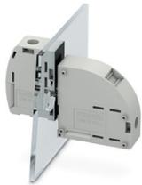
Morsetto d'esecuzione, tipo di connessione: Connessione a vite con gabbia, Connessione a vite con gabbia, numero poli: 1, corrente di carico: 150 A, direzione di connessione del conduttore alla direzione di inserzione: -90 °, larghezza: 18,8 mm, colore: grigio
