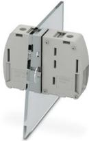
Morsetto d'esecuzione, tipo di connessione: Connessione a vite con gabbia, Connessione a vite con gabbia, numero poli: 1, corrente di carico: 232 A, direzione di connessione del conduttore alla direzione di inserzione: 0 °, larghezza: 25 mm, colore: grigio. Metà morsetto con flangia a vite
