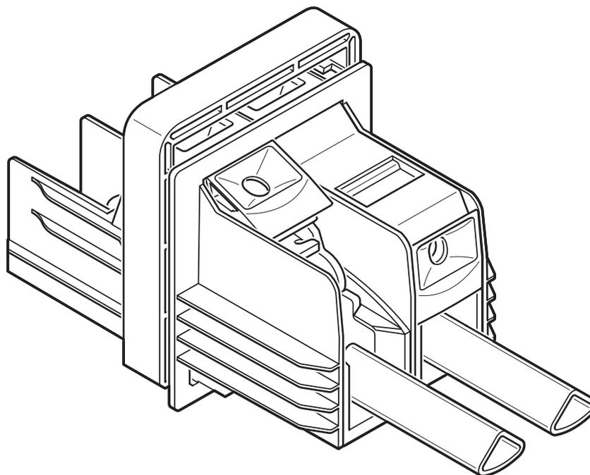
Disegno esemplificativo per posizione di inserimento di conduttori settoriali a un filo in alluminio
