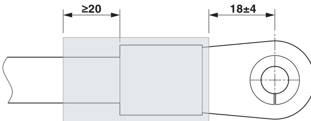
Rigidità dielettrica  $>19,7$  kV/mm (IEC243), min. Spessore della parete completamente crimpato  $\geq 0,5$  mm
