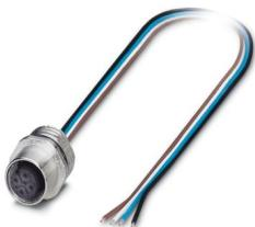
Connettore per apparecchi anteriore, Universale, 4-poli, Femmina, diritto, M12-Standard, codifica: A, su estremità conduttore libera, Montaggio anteriore, Pg9, Fili singoli, lunghezza cavo: 0,5 m, 0,34 mm<sup>2</sup>, Filo in TPE, saldato
