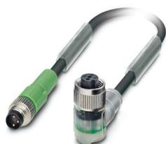
Cavo sensore/attuatore, 3-poli, PUR senza alogenati, grigio-nero RAL 7021, Maschio diritto M8, codifica: A, con 2 LED, su Connettore femmina angolato M12, codifica: A, con 2 LED, lunghezza cavo: 0,3 m
