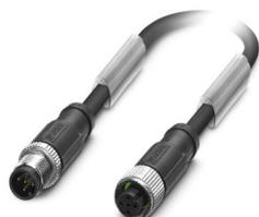
Cavo sensore/attuatore, 5-poli, PUR senza alogenati, grigio-nero RAL 7021, schermata (Advanced Shielding Technology), Maschio diritto M12, codifica: A, su Connettore femmina diritto M12, codifica: A, lunghezza cavo: 5 m
