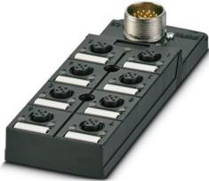
Scatola di distribuzione, applicazione: Standard, tipo di connessione: Connettore femmina M12 Plastica, numero degli slot: 8, numero poli: 5, codifica: A, occupazione slot: doppi, segnalazione di stato: no, Universale; connessione linea principale: Connessione M23 90°, schermatura: no
