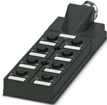
Scatola di distribuzione, applicazione: Standard, tipo di connessione: Connettore femmina M12 Plastica, numero degli slot: 8, numero poli: 5, codifica: A, occupazione slot: doppi, segnalazione di stato: no, Universale; connessione linea principale: Connessione M23 180°, schermatura: no
