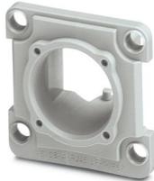
Telaio da incasso RJ45, IP67, per connessione a c.s., per sezione di montaggio rettangolare, con guarnizione, senza viti di fissaggio, colore: grigio
