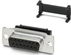
Inserto portacontatti D-SUB, grandezza linguetta 2, con 15 contatti di segnale, tipo contatto femmina, connessione flat cable, angolato, fissaggio mediante foro 3 mm, per telai da incasso VS-15-...
