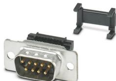
Inserto portacontatti D-SUB, grandezza linguetta 1, con 9 contatti di segnale, tipo contatto maschio, connessione flat cable, angolato, fissaggio mediante foro 3 mm, per telai da incasso VS-09-...
