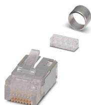
Inserto portacontatti maschio RJ45, CAT5e, 8 poli, schermato, connessione IDC, per filo AWG 26 e conduttori rigidi AWG 26 ... 24
