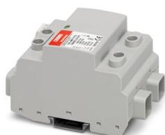
Scaricatore di corrente da fulmine / Limitatore di sovratensione di tipo 1/2 / classe I/II, per sistemi di alimentazione DC unipolari lineari fino a 1000 V DC, per montaggio su guida DIN con contatto di segnalazione remota.
