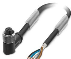
Cavo sensore/attuatore, 5-poli, PUR senza alogenati, grigio-nero RAL 7021, schermata (Advanced Shielding Technology), estremità conduttore libera, su Connettore femmina angolato M12, codifica: A, lunghezza cavo: 3 m
