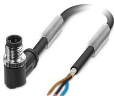
Cavo sensore/attuatore, 3-poli, PUR senza alogenati, grigio-nero RAL 7021, schermata (Advanced Shielding Technology), Maschio angolato M12, codifica: A, su estremità conduttore libera, lunghezza cavo: 1,5 m
