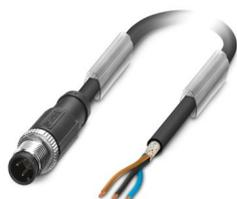
Cavo sensore/attuatore, 3-poli, PUR senza alogenati, grigio-nero RAL 7021, schermata (Advanced Shielding Technology), Maschio diritto M12, codifica: A, su estremità conduttore libera, lunghezza cavo: 3 m
