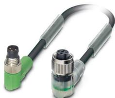
Cavo sensore/attuatore, 3-poli, PUR senza alogenati, grigio-nero RAL 7021, Maschio angolato M8, codifica: A, con 2 LED, su Connettore femmina angolato M12, codifica: A, con 2 LED, lunghezza cavo: 0,3 m
