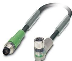
Cavo sensore/attuatore, 3-poli, PUR senza alogenati, grigio-nero RAL 7021, Maschio diritto M8, codifica: A, con 2 LED, su Connettore femmina angolato M8, codifica: A, con 2 LED, lunghezza cavo: 0,3 m
