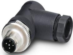
Connettore, Universale, 5-poli, Maschio angolato M12, codifica: A, Connessione a vite, materiale zigrinato: Pressogetto di zinco, nichelato, connessione a vite per cavo Pg9, diametro esterno conduttore 6 mm ... 8 mm
