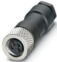
Connettore, Universale, 4-poli, Femmina diritto M8, codifica: A, Attacco a saldare, materiale zigrinato: Ottone, nichelato, diametro esterno conduttore 3,5 mm ... 5 mm
