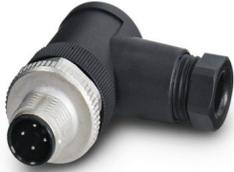
Connettore, Universale, 4-poli, Maschio angolato M12, codifica: A, Connessione a vite, materiale zigrinato: Pressogetto di zinco, nichelato, connessione a vite per cavo Pg7, diametro esterno conduttore 4 mm ... 6 mm
