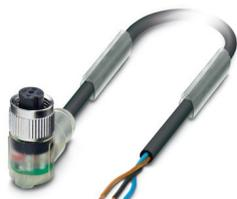
Cavo sensore/attuatore, 3-poli, PUR senza alogenati, grigio-nero RAL 7021, estremità conduttore libera, su Connettore femmina angolato M12, codifica: A, con 2 LED, PIN 2+4 ponticellati, lunghezza cavo: 10 m
